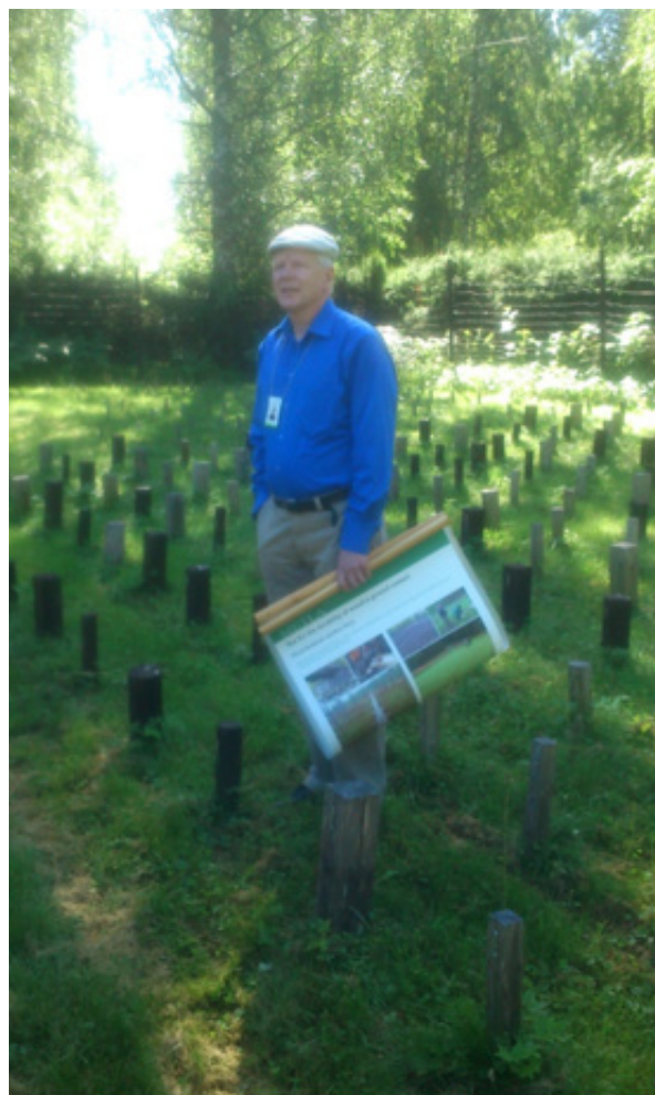
Fältförsök för test av rötmotstånd i lärkträ och vid jämförelse med impregnerad furu.
