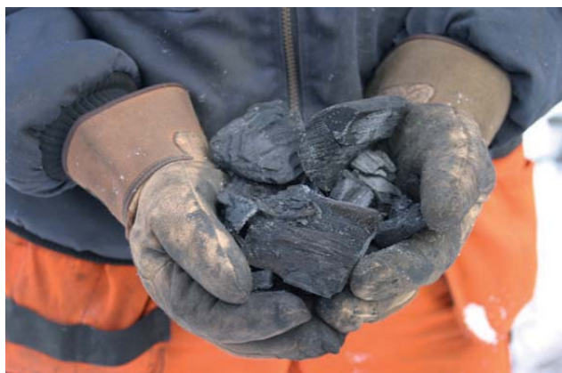
Marktinningskol tinar 1 meter tjäle på 8-12 timmar. Alternativet är diesel- eller gasol drivna aggregat.
