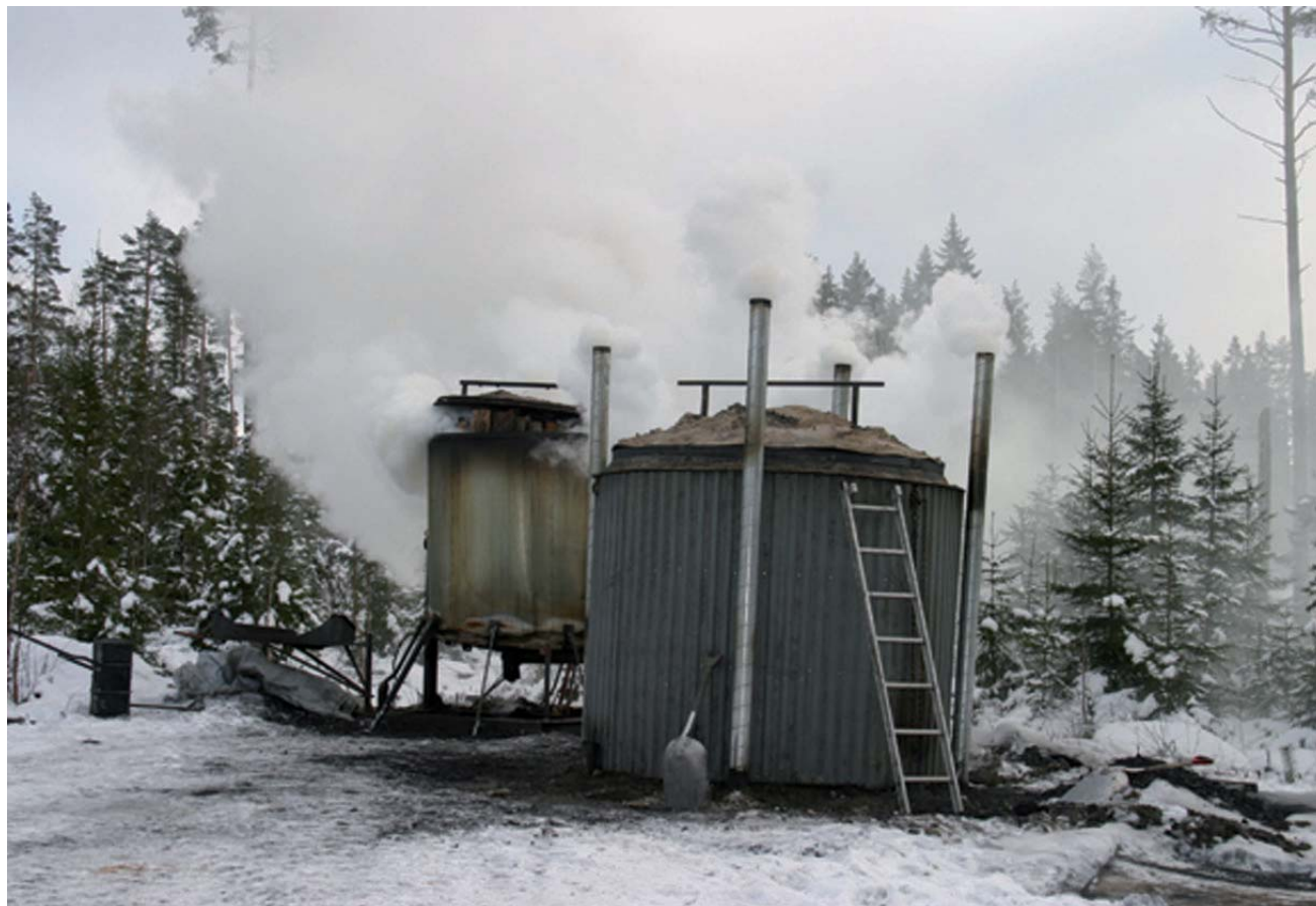
Hemmabyggen: Milan till vänster är tippbar och rymmer knappt 5 m 3 . Den högra milan är en ombyggd cistern från ett vattenverk, den står direkt på marken och rymmer 10 m 3 . Utbytet är 40-50 procent.
